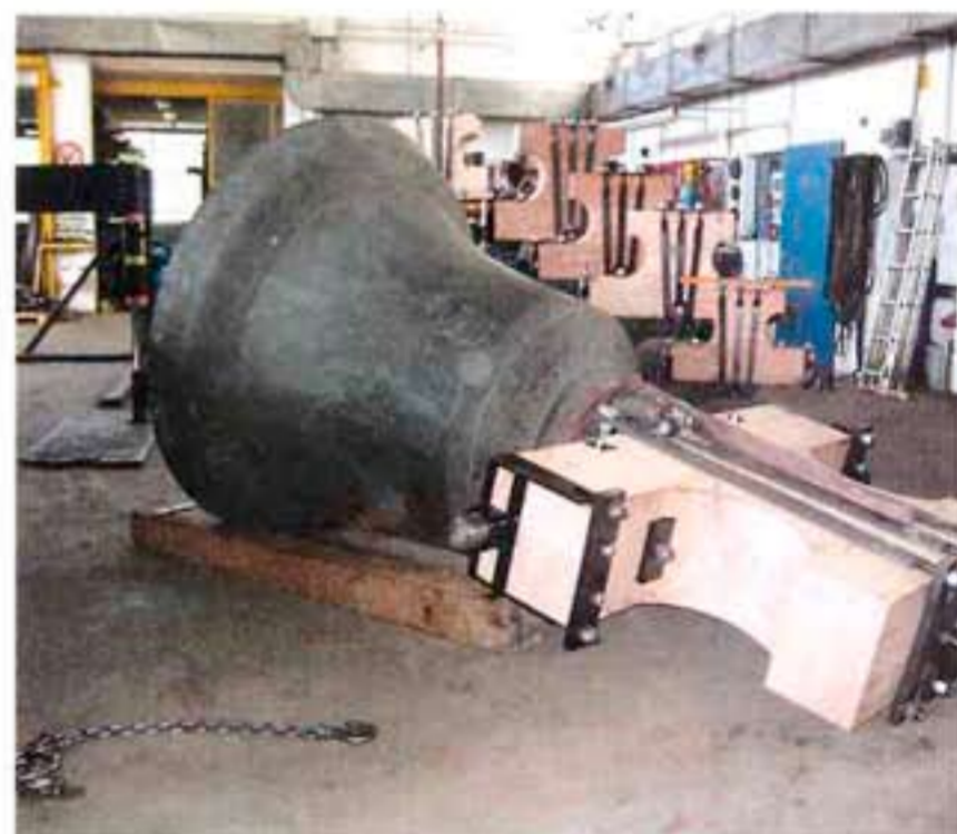
Die Glocke wurde samt neuer Joche gewogen, um das neue Gegenpendel darauf einzustellen.
